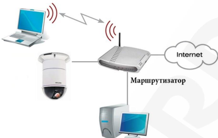
Как правило, в домашних маршрутизаторах предусмотрены один WAN-порт для подключения к сети Интернет и четыре внутренних LAN-порта для подключения компьютеров, IP-камер и других устройств домашней сети. Кроме того, маршрутизатор может иметь Wi-Fi интерфейс для подключения беспроводных устройств, например ноутбука.
