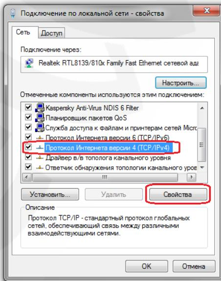
Откроется окно, в котором отображается информация о настройках сетевого подключения. Возможны два варианта настройки IP-адреса сетевого подключения Вашего ПК:
