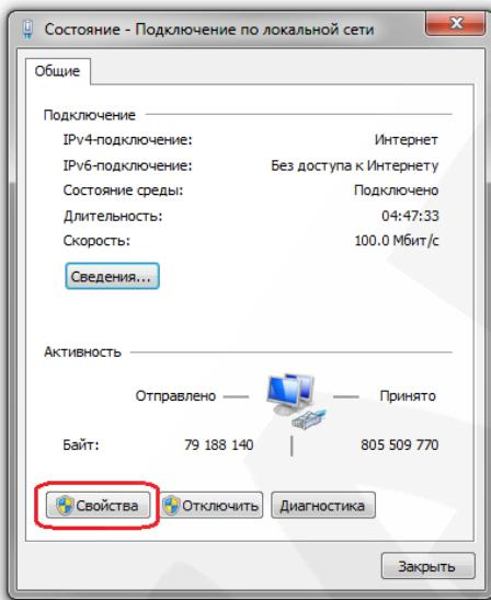
В диалоговом окне свойств сетевого подключения необходимо выбрать пункт **[Протокол Интернета версия 4 (TCP/IPv4)]** и нажать кнопку **[Свойства]**
