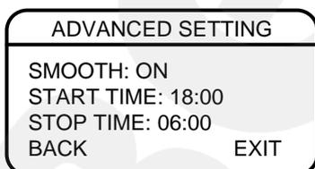
**<ADVANCED>**: данное меню содержит пункты “**START TIME**”, “**STOP TIME**” для установки расписания включения/выключения ИК-подсветки в режиме “**TIMING**” (см. выше) и опцию “**SMOOTH**” для плавного включения подсветки в этом же режиме.
